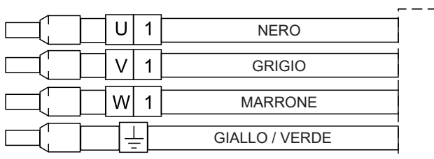
Identificazione conduttori cavo elettropompe
